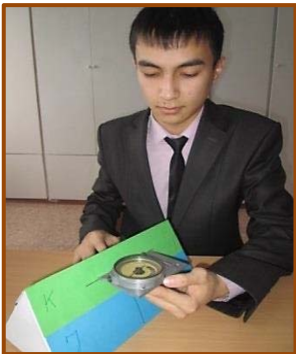
Рисунок 26. Определение азимута азимута простирания пласта
