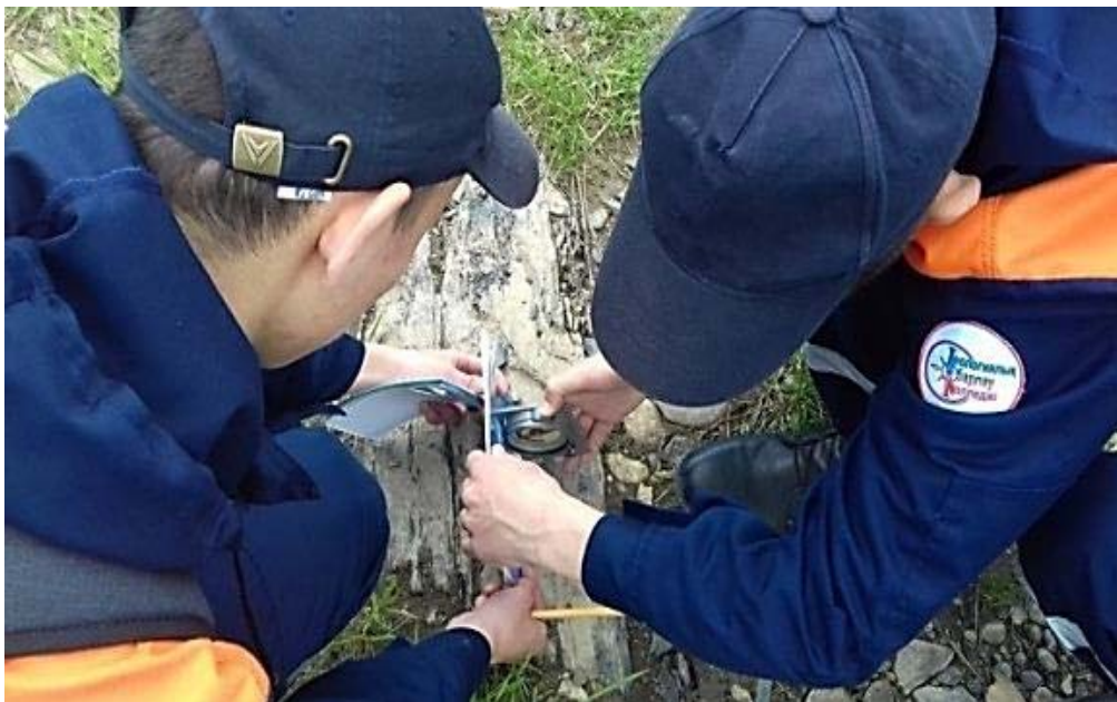
Рисунок 30. Измерение угла падения пласта в полевых условиях
